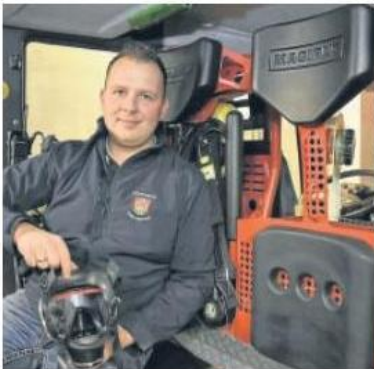
Eine Atemschutzmaske muss eng auf der Haut anliegen: Markus Richter, stellvertretender Wehrführer der Feuerwehr Frielendorf, zeigt die Dichtlippe eines Atemschlusses. Foto: Matthias Haaß
